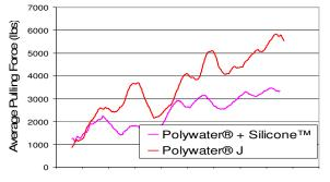
Graph 3. Running Average Tension of Polywater<sup>®</sup> J vs Polywater<sup>®</sup> + Silicone<sup>™</sup>
