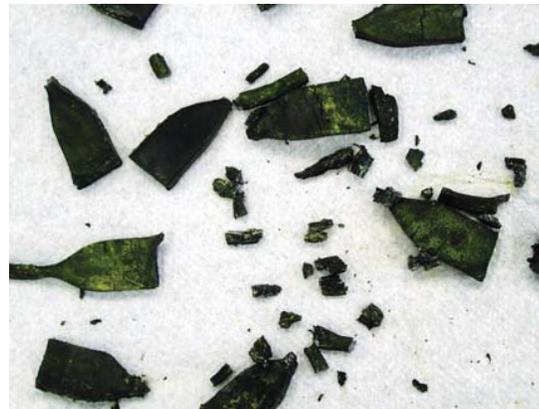
*Des lubrifiants à base de cire ont détruit quelques gaines LSZH dans des tests de vieillissement.*
